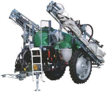
Livellamento automatico di barre per la fertirrigazione in campo
